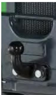
Es sind zwei Typen von Anhängerkupplungen erhältlich. Eine Anhängerkupplung mit 50 mm Kugelkopf und eine Anhängerkombikupplung mit 50 mm Kugelkopf und Zugmaul. Beide Anhängerkupplungen werden entweder direkt am Heckgewicht oder der Stoßstange montiert. Die AVANT 200 Serie ist serienmäßig mit einer 50 mm Kugelkopfkupplung ausgestattet.
