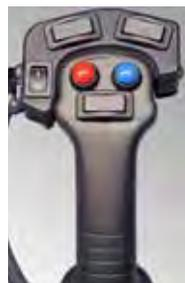
Opticontrol ermöglicht es sowohl die elektrischen wie auch die hydraulischen Funktionen der Anbaugeräte mit den Knöpfen des Joystick zu bedienen. Dafür wird an dem Lader der Joystick mit 6/8-fach Funktion benötigt. Opticontrol vereinfacht und beschleunigt die Bedienung und Vielfältigkeit der Anbaugeräte die mehrere Hydraulik und Elektrofunktionen haben. Es besteht aus dem Schalter-Kit der auf der Schaltereinheit des Joystick befestigt wird und einem Schalter der im Bedienfeld eingebaut ist.
