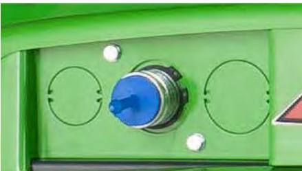
Für den Betrieb einfachwirkender Anbaugeräte wie z.B. Reitbahnplaner oder Kipphanhänger ist die Heck-Zusatzhydraulik erforderlich. Die einfachwirkende Zusatzhydraulik ist mit einer Druckleitung ausgestattet und macht den Einsatz von im Heck montierten einfachwirkenden Anbaugeräten möglich.
