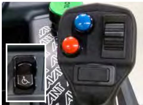
Der elektronisch vorgesteuerte hydraulische Fahrtrieb wird anstelle per Fahrpedal über einen 8-fach-Joystick bedient - so können acht Funktionen von Hand gesteuert werden: Heben, Senken, Einkippen, Auskippen, Vorwärts, Rückwärts, Hydraulikvorlauf und Hydraulikrücklauf. Mit einem Schalter auf dem Armaturenbrett kann dabei zwischen Steuerung per Fahrpedal oder per Handsteuerung gewählt werden.
