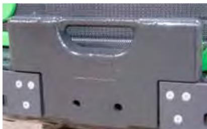
Das 29 kg schwere Heck-Zusatzgewicht mit Griff sorgt bei schwerer Beladung des Laders für zusätzliche Stabilität und ist mit den Befestigungshaken leicht an- und abzubauen. Die beiden ebenfalls optional erhältlichen Anhängerkupplungen können in das Zusatzgewicht integriert werden.
