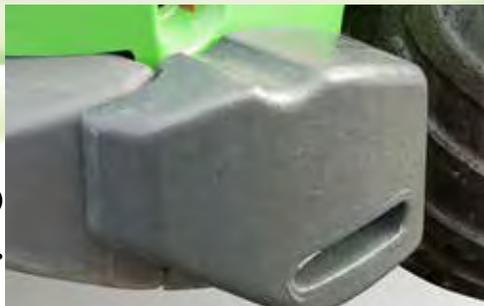
Das 180 kg Heck-Seitengewicht-Set besteht aus 2 je 90 kg schweren Heck-Seitengewichten, die rechts und links hinter den Hinterrädern des Laders montiert werden. Die Gewichte steigern Hubkraft und Stabilität beim Umgang mit schweren Lasten.
