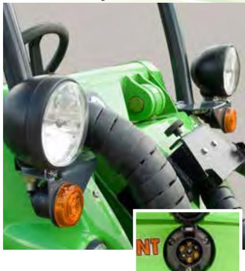
Das Paket beinhaltet Scheinwerfer, Blinker, Rundumleuchte, Reflektoren, einen Spiegel und das Warndreieck im Heck der Maschine. Das Kommunalpaket ist normalerweise eine Voraussetzung zur Erteilung einer Straßenzulassung, bitten nehmen Sie Kontakt mit Ihrem Avant-Händler.
