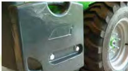
Das 80 kg Heck-Seitengewicht-Set besteht aus 2 je 40 kg schweren Heck-Seitengewichten, die rechts und links vom Lader montiert werden. Das 80 kg-Set ist speziell für die kleineren AVANT-Serien konstruiert, kann aber auch an den größeren AVANT-Modellen verwendet werden. Die Gewichte steigern Hubkraft und Stabilität beim Umgang mit schweren Lasten.
