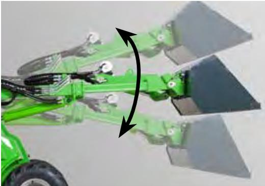
Der Schwingungsdämpfer arbeitet wie ein Stoßdämpfer für den Hubarm. Er steigert die Stabilität des Hubarmes bei hohen Fahrgeschwindigkeiten und verhindert so das Schaukeln oder Wackeln der Ladung auf der Palettengabel, in der Schaufel etc. Der Schwingungsdämpfer erfordert die Ausstattung des Laders mit Parallelführung und Niveaueingleich.
