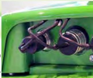
Für den Betrieb doppelwirkender Anbaugeräte wie z.B. Kreiselegge ist diese Heck-Zusatzhydraulik erforderlich. Die doppelwirkende Zusatzhydraulik ist mit einer Druck- und einer Rücklaufleitung ausgestattet (in der AVANT 400-700 Serie zusätzlich mit einem drucklosen Rücklauf), und macht den Einsatz von im Heck montierten doppelwirkenden Anbaugeräten möglich, z.B. Sandstreuer etc. Bei der Ausstattung des Laders mit der optionalen Handsteuerung ist keine doppelwirkende Heck-Zusatzhydraulik möglich.
