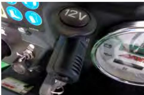
Der Adapterstecker wird am 12V-Anschluß des Laders angeschlossen. Die elektrische Leitungen von einem 12V Elektrogerät, z. B. ein Batterieladegerät, können im Stecker eingekuppelt werden.
