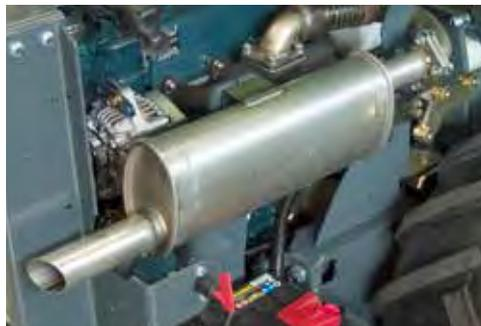
Der Abgas-Katalysator ersetzt den Originalschalldämpfer und ist Katalysator, Schalldämpfer und Funkenfänger in einem. In dem Kohler KDI Stage V Motor ist ein Diesel Oxidations Katalysator (DOC) integriert in dem Gehäuse zusammen mit dem Diesel Partikel Filter DPF.
