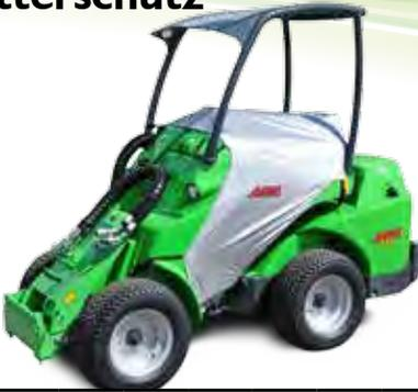
Der AVANT Wetterschutz schützt Cockpit und Sitz vor Regen, Schnee, Staub und anderen Verschmutzungen. Der wetterfeste Überzug schützt das komplette Fahrerhaus: Instrumententafel, Steuerrad und Sitz. Der AVANT Regenschutz ist mit einer integrierten Tasche ausgestattet, in der der Überzug bei Nichtgebrauch aufbewahrt werden kann.
