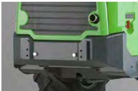
Die AVANT 500- und 600-Serie kann bei Bedarf anstelle des serienmäßigen 170 kg Heckgewichtes mit einer leichten Stoßstange ausgestattet werden. Dies reduziert das Gewicht um ca. 150 kg, was auf empfindlichem Untergrund oder bei eingeschränkter Tragfähigkeit des Untergrundes nützlich sein kann.
