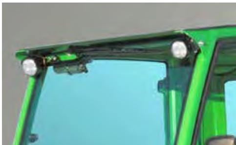
Die zusätzlichen LED-Arbeitsscheinwerfer ermöglichen den sicheren und effizienten Einsatz des Laders auch bei Dunkelheit und können auch an einer Leichtkabine LX montiert werden. Sie haben die Wahl zwischen LED-Scheinwerfern mit 700 Lumen oder 2500 Lumen. Die 3 Leuchten werden im Front- (2) und Heckbereich (1) montiert.
