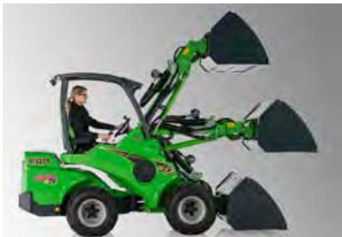
Die hydraulische Parallelführung ist besonders bei Ladetätigkeiten mit der Palettengabel oder beim Handling von schweren Lasten eine unverzichtbare Option und macht die Bedienung des Laders schneller, präziser und leichter.
