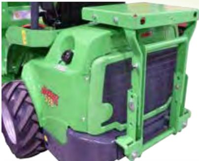
Der klappbare Heckträger wird am Heck mit Bolzen befestigt. Der Träger ist Standardausrüstung auf Generator, Kompressor und Hochdruckreiniger mit Heckmontage.
