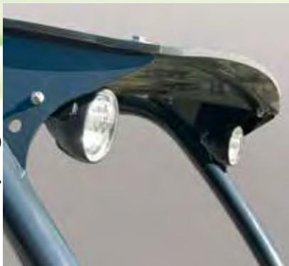
Die zusätzlichen LED-Arbeitsscheinwerfer ermöglichen den sicheren und effizienten Einsatz des Laders auch bei Dunkelheit. Sie haben die Wahl zwischen LED-Scheinwerfern mit 700 Lumen oder 2500 Lumen. Die 3 Leuchten werden im Front- (2) und Heckbereich (1) montiert.
