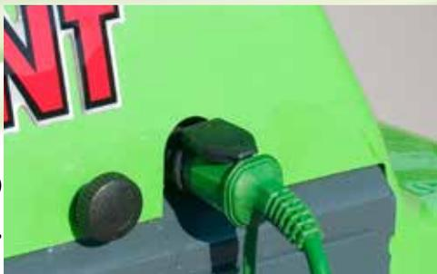
Der Motorvorwärmer erleichtert das Starten des Laders bei Umgebungstemperaturen im Minusbereich und reduziert gleichzeitig Kraftstoffverbrauch und Schadstoffausstoß.
