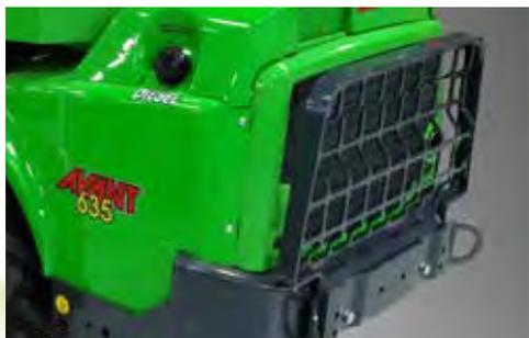
Der Heckschutz schützt Lüfter und Heck des Laders. Der Schutz wird an den Befestigungen im Heck montiert. Zurrösen sind in den Schutz bereits integriert und auch Anhängerkupplungen oder Heckgewicht können an einem mit Heckschutz ausgestatteten Lader montiert werden. Der Heckschutz kann je nach Bedarf schnell und einfach an- und abgebaut werden.
