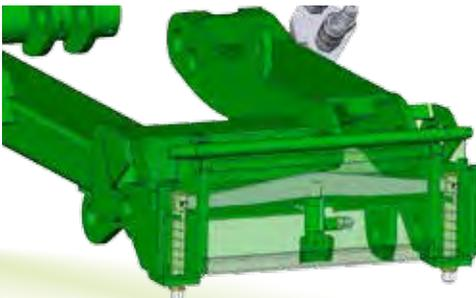
Mit der hydraulischen Entriegelung können Anbaugeräte schnell und mühelos automatisch direkt vom Fahrersitz aus entriegelt werden. Die Verriegelungsbolzen werden vom Fahrersitz aus gesteuert und bewegen sich hydraulisch. So gelingt der Anbaugerätewechsel noch schneller.
