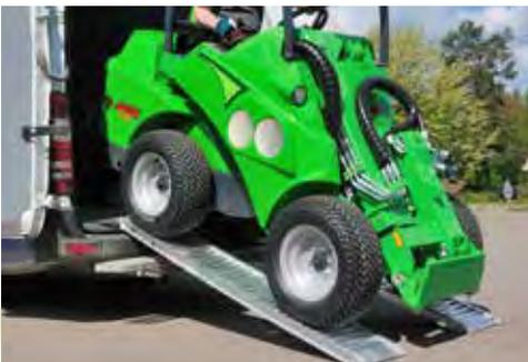
Die Laderampen machen es leicht, die AVANT Multifunktionslader auf Ihren Anhänger oder in Ihren Transporter zu fahren. Die leichten Aluminiumrampen sind einfach zu handhaben und bleiben durch die Gitterkonstruktion vor Verschmutzung weitgehend geschützt. Die maximale Belastung beträgt 2.250 kg.
