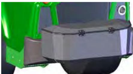
Box für Aufbewahrung und Transport von Werkzeug, Ausrüstung etc., die auf die Stoßstange im Heck der Maschine aufgeschraubt ist. Der Deckel kann bei Bedarf abgeschlossen werden.
