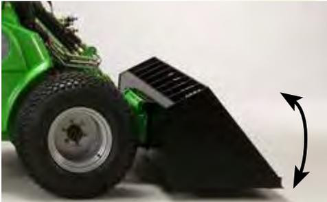
Auch Lader mit Parallelführung können mit dem Niveaueingleich ausgerüstet werden. Bei der 800 er Serie Niveaueingleich Standard. Der Niveaueingleich umgeht die Parallelführung des Hubarmes, was bedeutet, dass die Parallelführung des Hubarmes ohne Funktion ist, wenn der Niveaueingleich eingeschaltet ist.
