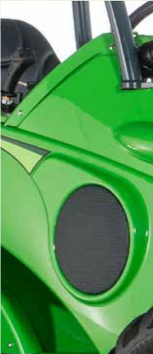
Die HD-Verkleidung ist aus hochbelastbarem Polycarbonat mit hoher Reißfestigkeit hergestellt und wird anstelle der serienmäßigen ABS-Verkleidung montiert. Die HD-Verkleidung empfiehlt sich für Einsätze unter extremen Bedingungen, z.B. im Abbruch.
