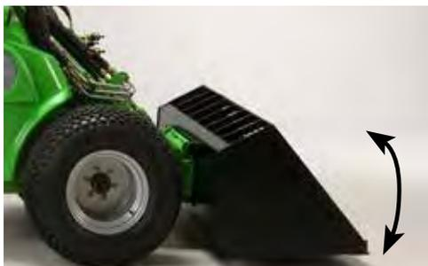
Der Niveaueingleich sorgt für freie Beweglichkeit der Anbaugeräte, die damit den Bodenkonturen folgen - besonders hilfreich bei der Arbeit mit Schaufel oder Schneeschild. Der Niveaueingleich wird per Schalter im Armaturenbrett ein- und ausgeschaltet.
