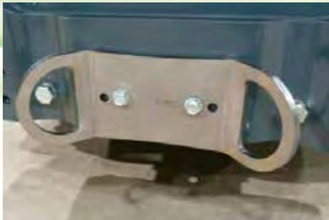
Eine einfache Zurröse zum schnellen Verzurren Ihres Laders beim Transport. Die Zurröse kann entweder im Heck oder seitlich hinten am Lader montiert werden; darüber hinaus ist auch die Montage zwischen Heck und Anhängerkupplung möglich. So kann die Zurröse auch mit montierter Anhängerkupplung verwendet werden.
