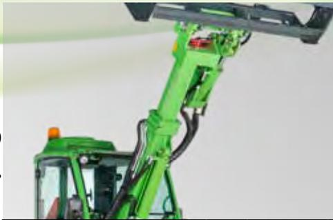
Mit dem Teleskophubarm heben Sie Lasten höher und erreichen auch schwerer zugängliche Arbeitsbereiche. Der Teleskophubarm erlaubt mehr Flexibilität bei allen Ladevorgängen: stufenloses und exaktes Ein- und Ausfahren des Hubarmes, ohne den Lader bewegen zu müssen. Die Bedienung erfolgt über den Bedienhebel im Armaturenbrett. Die Modelle der 500 - 700 Serie sowie der e- und R-Serie sind serienmäßig mit dem Teleskophubarm ausgestattet.
