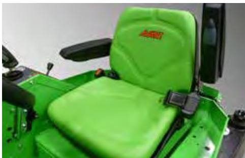
Der gefederte Sitz ist optional für die AVANT 200- und 400 Serie erhältlich und ausgestattet mit Armlehnen, Sicherheitsgurt und Sitzheizung.
