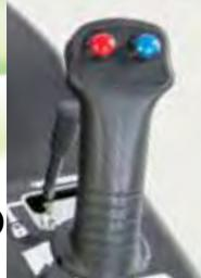
Mit dem 6-fach Joystick können hydraulisch betriebene Anbaugeräte mit zwei Knöpfen am Joystick gesteuert werden. So arbeiten Sie komfortabler und schneller, ohne die Bedienhebel wechseln zu müssen. Gleichzeitig können Hubarm und Geräteanbauplatte bedient werden.
