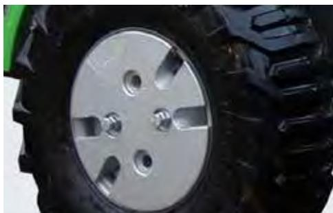
Die AVANT 200 Serie kann mit 14 kg schweren Radgewichten ausgerüstet werden, die mit speziellen Bolzen an der Felge montiert werden. Sie halten den Schwerpunkt des Laders tief und erhöhen die Stabilität besonders in unebenem Terrain oder in Waldgebieten.
