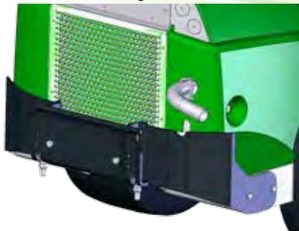
Ermöglicht die Montage und den Transport von Anbaugeräten im Heck. Das serienmäßige 170 kg Heckgewicht mit der Stoßstange muss entfernt werden und es können keine Heckgewichte, Heck-Seitengewicht-Sets oder Anhängerkupplungen verwendet werden.
