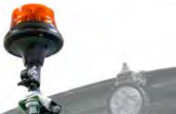
Die Warnleuchte ist mit breiten LED-Lampen ausgestattet. Sie wird auf einem kippbaren Sockel installiert und ist leicht an- und abzubauen.
