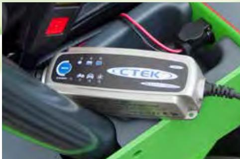
Mit dem Batterieladegerät können Sie die Batterie über den 12V Zugang der Maschine laden, ohne die Abdeckung abnehmen zu müssen. Das Ladegerät arbeitet vollautomatisch - wechselt automatisch zwischen Lade- und Bereitschaftsmodus. Eine nützliche und empfehlenswerte Ausstattung für Maschinen, die saisonal im Einsatz sind und längere Zeit unbenutzt stehen.
