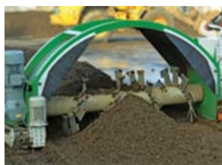
Die massive Bogenkonstruktion aus 5 mm Stahl sorgt für eine sehr grosse Stabilität.
