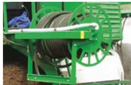
Schlauchhaspel mit Schlauchführung-Automatik. Wickelt Schläuche bis ca. 80 Meter automatisch in der Fahrgeschwindigkeit auf und ab.
