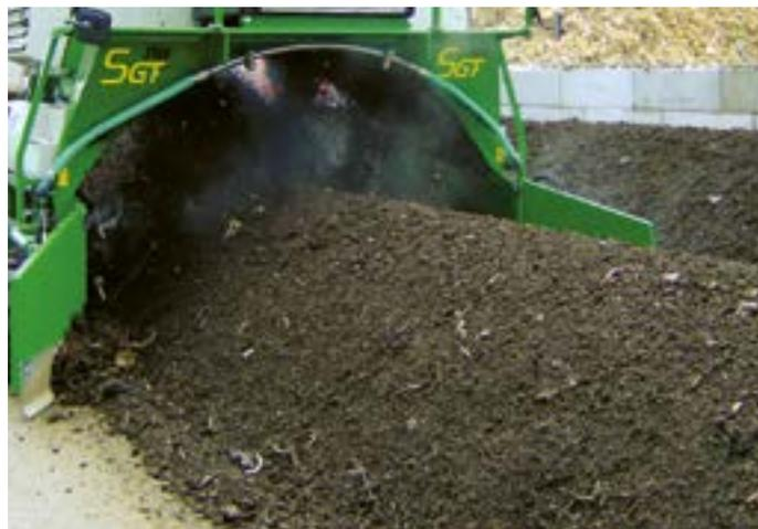
Mit der SGF 3100 gelingt das Kompostieren einfach und schnell. Dies liegt vor allem an der perfekt arbeitenden Umsetzwelle, die das Material von innen nach aussen fördert.
