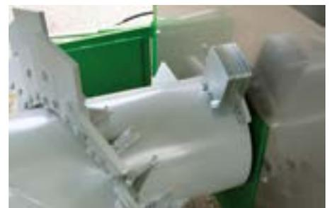
15 mm Schlägerdicke mit 3 Befestigungsschrauben. Die gewuchtete Welle sorgt für eine lange Lebensdauer.
