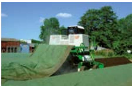
Vlieswickler hydraulisch höhenverstellbar. Vliesrolle mit Schnellwechselsystem.
