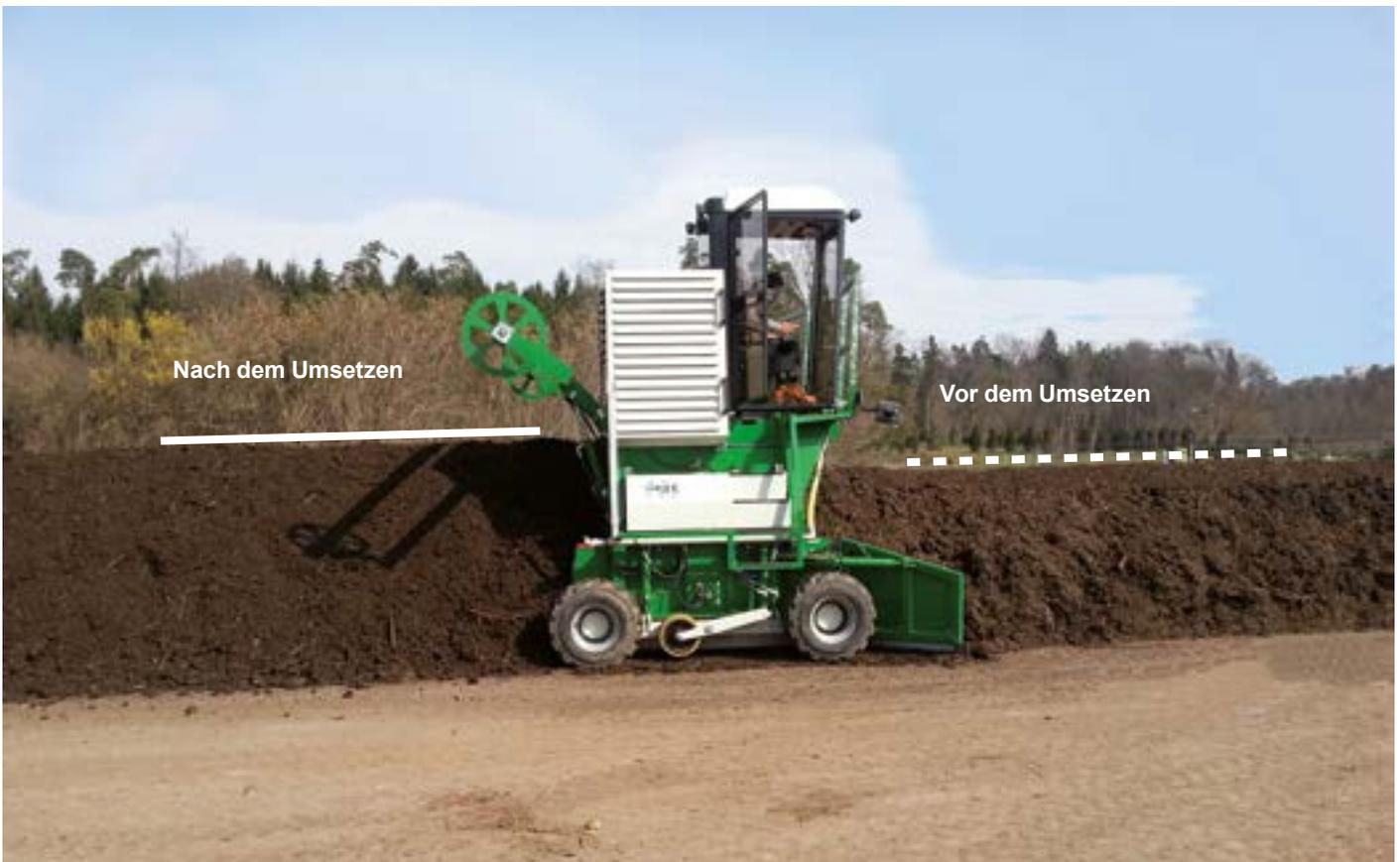
Gleichmässige, effektive und effiziente Lockerung des Kompostmaterials, damit der Sauerstoff optimal zirkulieren kann. So gewähren wir einen optimalen Rotteprozess. Anhand der weissen Linie sieht man eindrücklich die Lockerung vor und nach dem Umsetzen.
