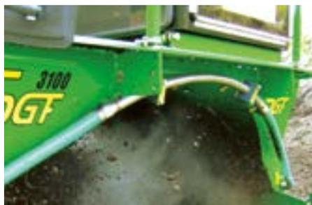
Einfache Bewässerung mittels Wasserbalken. Für die Erreichung eines optimalen Mikroorganismus-Klimas innerhalb der Miete ist die Zugabe von Wasser unerlässlich.
