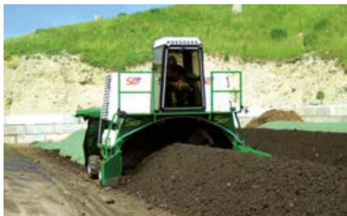
Die SGF 3100 ist eine kompakte, leistungsstarke, einfach zu bedienende, selbstzufahrende Kompostwendermaschine. Ideal für grössere Unternehmen und Kommunen mit einer Kompostierung von 2'000 bis 10'000 Jahrestonnen.
