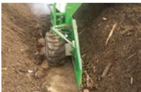
Einzel schwenkbare, hydraulische Schilde sorgen für saubere Mietengassen.
