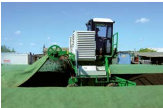
Vlieswickler hydraulisch höhenverstellbar. In einem Arbeitsgang wird umgesetzt und gleichzeitig das Vlies abgelegt. Mit dem Schnellwechselsystem ist das anbringen einer neuen Vliesrolle ein Kinderspiel. Dank optional erhältlicher Fernbedienung lässt sich das Aufwickeln von aussen begleiten.
