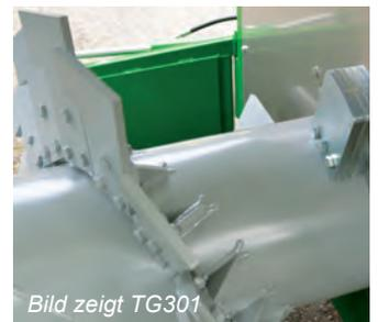
12 mm Schlägerdicke mit 2 Befestigungsschrauben. Die gewuchtete Welle sorgt für eine lange Lebensdauer.
