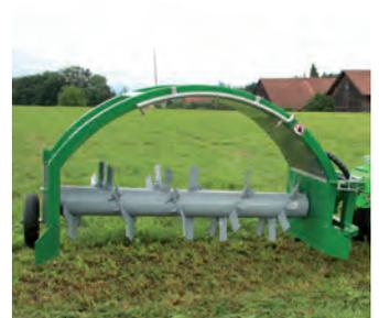
Die massive Bogenkonstruktion aus 5 mm Stahl sorgt für eine sehr grosse Stabilität.
