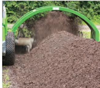
Mit der TG 201 gelingt das Kompostieren einfach und schnell. Dies liegt vor allem an der perfekt arbeitenden Umsetzwelle, die das Material von innen nach aussen fördert, damit die Mikroorganismen sich überall optimal vermehren können.
