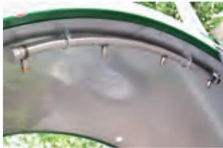
Bewässerungsanschluss mit Verteildüsen. Für die Erreichung eines optimalen Mikroorganismus-Klimas innerhalb der Miete ist die Zugabe von Wasser unerlässlich.
