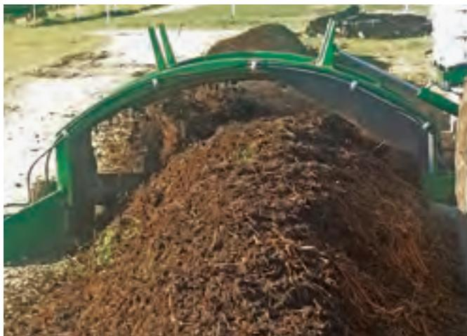
Mit der TG 231 gelingt das Kompostieren einfach und schnell. Dies liegt vor allem an der perfekt arbeitenden Umsetzwelle, die das Material von innen nach aussen fördert.
