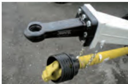
Standard-Anhängekupplung vorne: DIN-Zugöse
