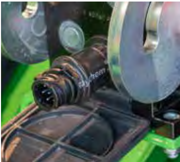
Adapter für Multikupplung mit Elektroanschluss (Anbaugerät) A36679
