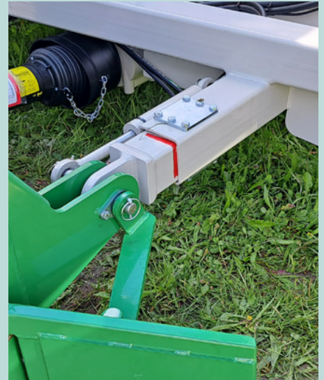
Hydraulischer Seitenversatz, damit die Miete da bleibt wo sie hingehört. (Bild TG 301)
