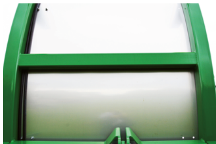
Alle Verschleissbleche sind aus Chromstahl.
