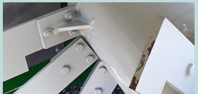
Lange Schlegel 260x80x15 - für schweres Umsetzmaterial von Vorteil
