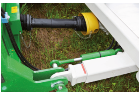
Direkter Antrieb – Getriebe auf Umsetzwelle
