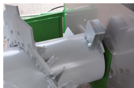
12 mm Schlagerdicke mit 3 Befestigungsschrauben. Die gewuchtete Welle sorgt für eine lange Lebensdauer.
